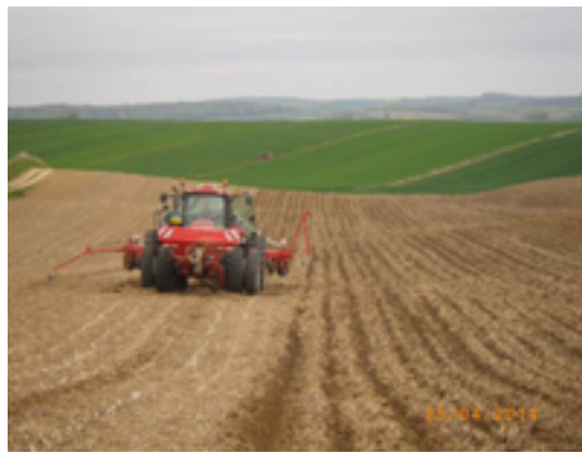
Ryc. 1. Zestaw do uprawy gleby, wysiewu nawozów i siewu kukurydzy w jednym przejeździe roboczym (konstrukcja: W. Gryn).
