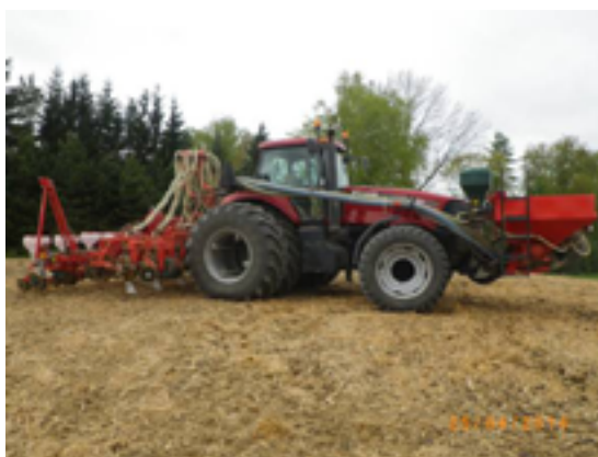
Ryc. 1. Zestaw do uprawy gleby, wysiewu nawozów i siewu kukurydzy w jednym przejeździe roboczym (konstrukcja: W. Gryn).
